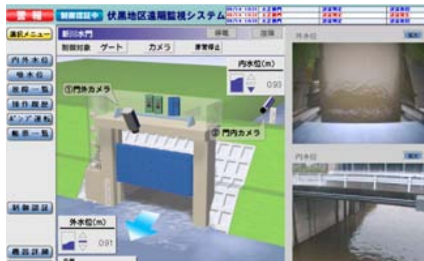
河川管理施設の遠隔監視システム
