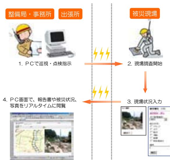
河川巡視点検システムのイメージ
