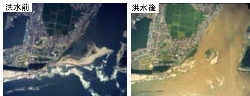
平成14年7月洪水による河口砂洲の変化
