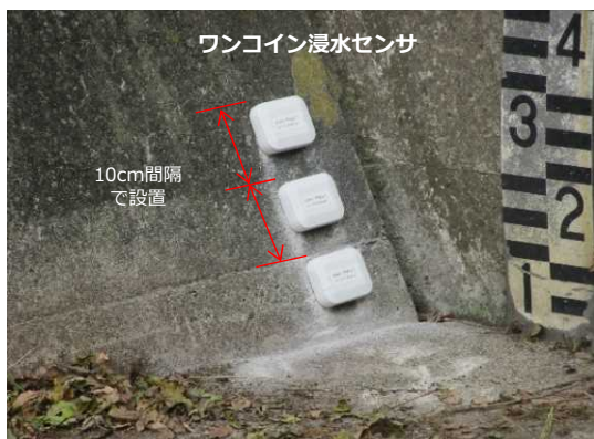
◀▲浸水常襲箇所に浸水センサ設置
