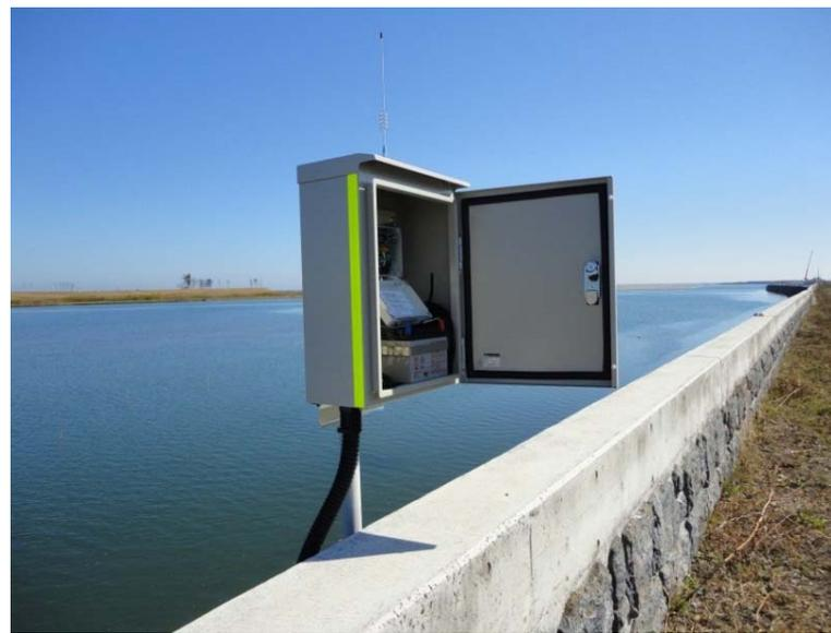
簡易水位計設置の例
