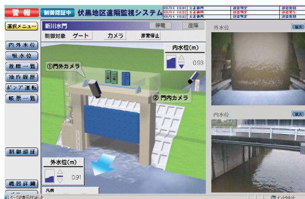
図 5-34 河川管理施設の遠隔監視システム
