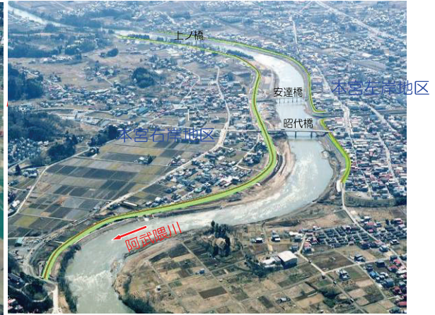
本宮左岸・右岸地区(断面不足箇所) 左岸 河口より117.8～119.8km 右岸 河口より117.2～119.8km
