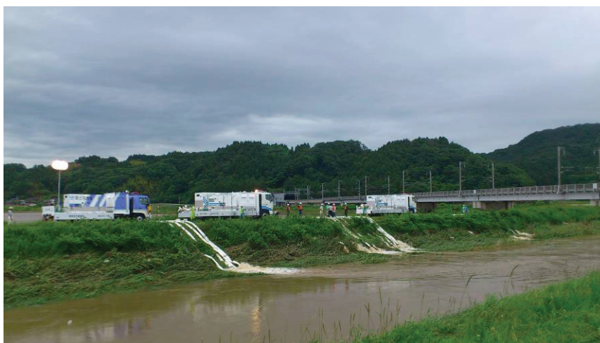
排水ポンプ車の活動状況
