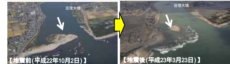
斜め写真:地震前では、河口部において砂州の発達が顕著にみられるが、地震後には津波により砂州がフラッシュされている。
