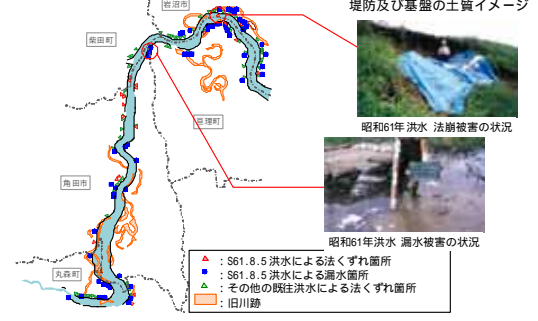
図 3-6 既往洪水における堤防の被害(阿武隈川宮城県区間)
