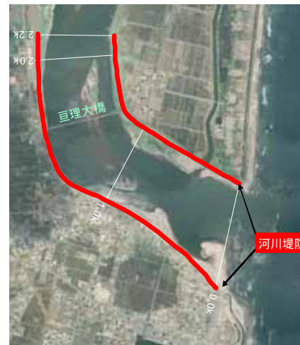
河口部の堤防整備イメージ(0.0k付近)
