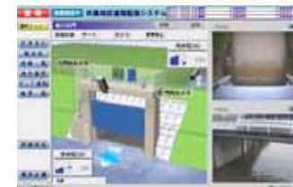
図 5-34 河川管理施設の遠隔監視システム
