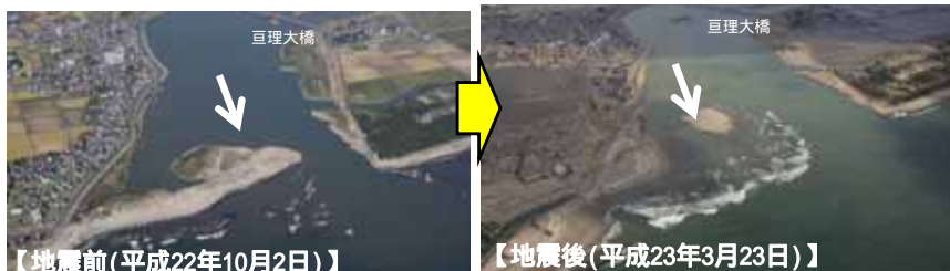
斜め写真：地震前では、河口部において砂州の発達が目立ちみられるが、地震後には津波により砂州がフラッシュされている。
