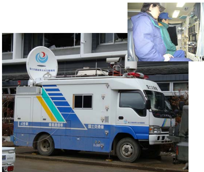
東日本大震災での衛星通信車稼働状況 （宮城県石巻市）
