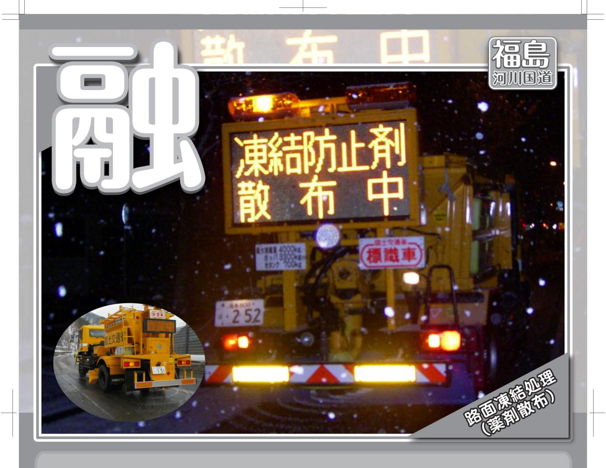
路面凍結処理は、<u>通行車両の安全で円滑な</u> 交通の確保を目的として、スリップ事故等防 止の安全対策として行われる作業です。
