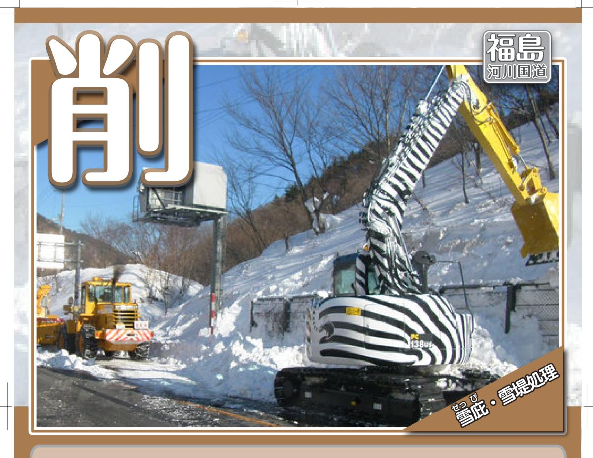
雪庇・雪堤処理は、<u>高積雪地域において、</u> 通行車両の安全性を確保するために、雪庇・ 雪堤の崩落を回避することを目的に行う作業 です。
