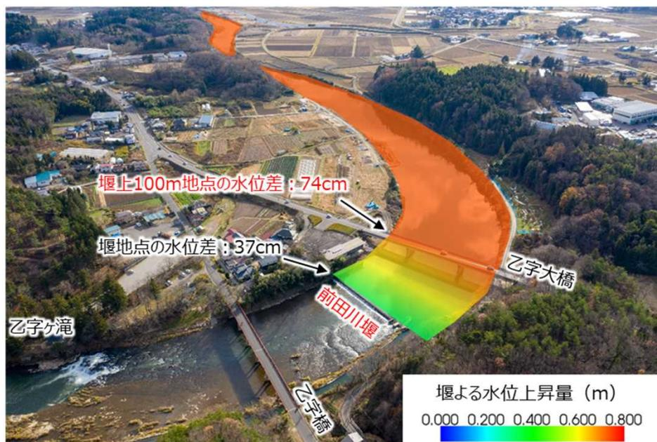
洪水時(令和元年東日本台風)の堰による水位上昇量
