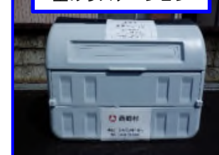
土のうステーション
