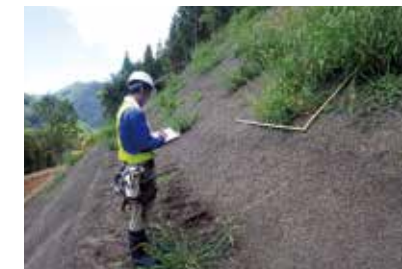
法面緑化後のモニタリング調査
