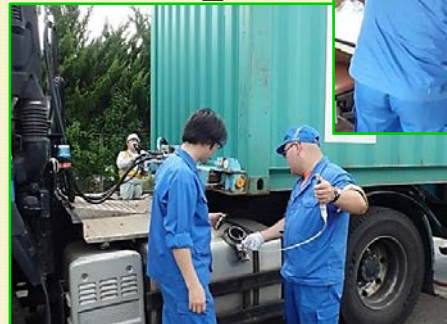
燃料（軽油）を抜き取り、硫黄濃度を測定中
