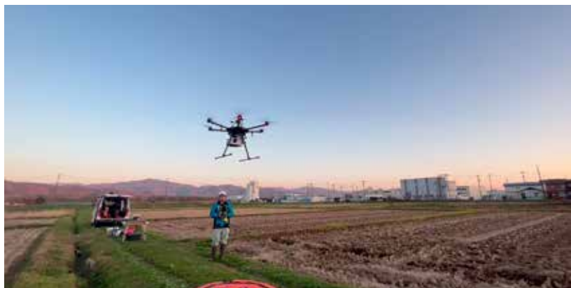
UAVによる路線測量(盛岡南道路)
