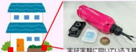
実証実験に用いている3種類の浸水センサ
