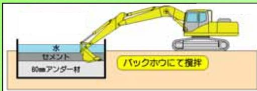
ふるい分けを行った土砂にセメントと水を加えて練り混ぜます。
