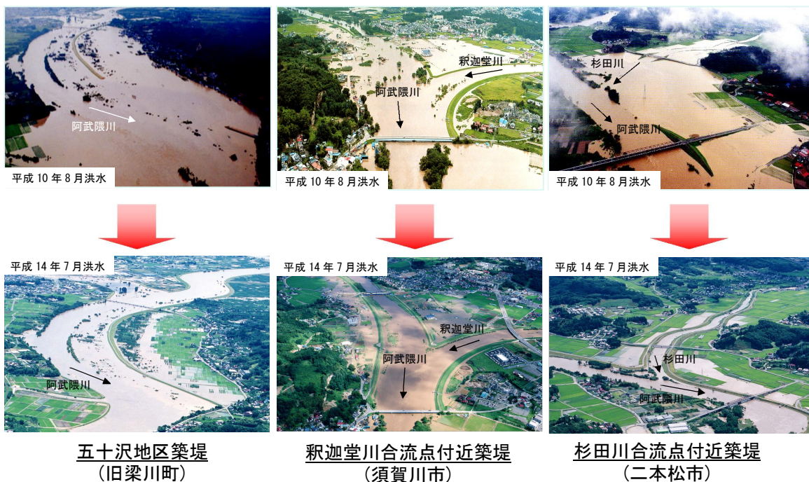
図 2-1-2 平成の大改修による築堤の効果
