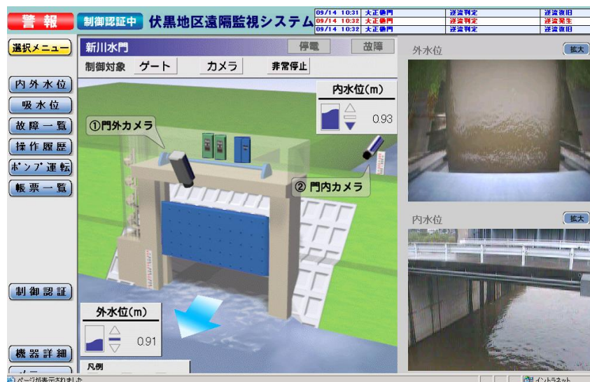
図 5-3 1 河川管理施設の遠隔監視システム
