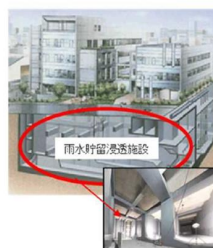
雨水貯留浸透施設の整備イメージ
