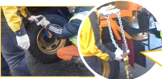
緊急脱出用チェーン。雪道でタイヤがスタックした際の緊急脱出用として効果を発揮します！
