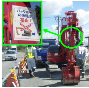
▲バックホウに後退禁止の明示
