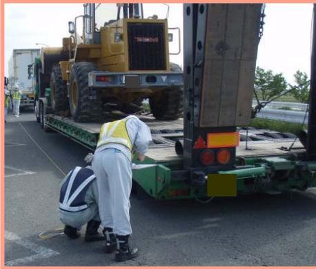
▲車体の高さ・幅・長さを測定します
