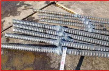
繋ぎ合わせた鉄筋の強度は1本の鉄筋と同等以上になります！施工する前に必ず引張り試験という、所定の強度があるかどうかの試験を行います！
