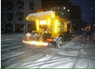
●散布車による凍結抑制剤散布
