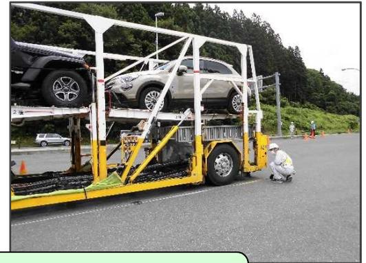
**2** 車体の高さ・幅・長さを測定
