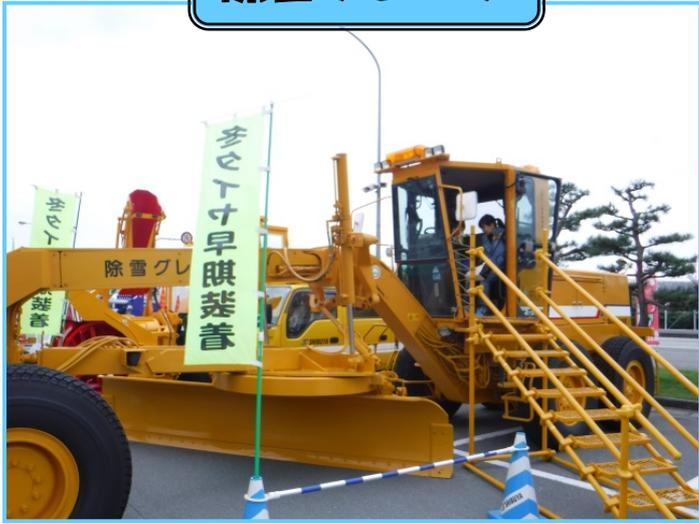
押し潰されて堅くなった道路の雪を、ブレード（排雪板）で削り取って平らにする機械です。
