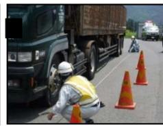
車体の高さ・幅・長さを測定
