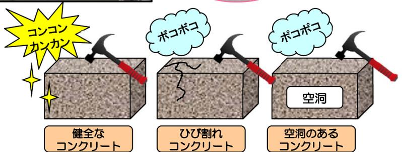
ハンマーで叩いた時の音の違いで、トンネルや橋のコンクリートの内部などの状態を調べる、コンクリート打音検査を体験していただきました。
