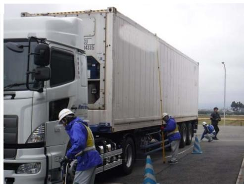
車体の高さ・幅・長さを測定
