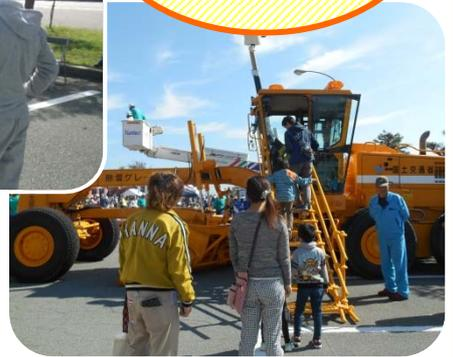
車の走行でかたくなった道路上の雪を、ブレード(排雪板)で削り取って平らにする機械です。
