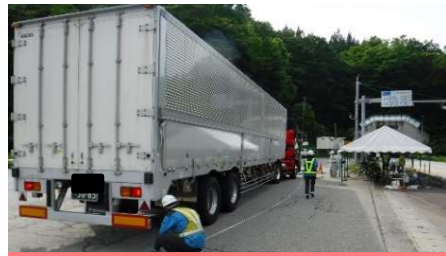
車体の高さ・幅・長さの計測
