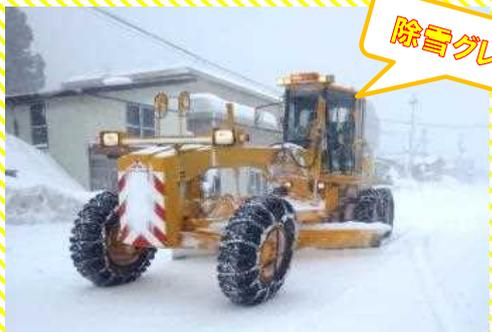
運転席の下にある刃（フレード）で雪を押しながらか片側に寄せます。スピードは出ませんが、パワーのある除雪グレーダは、**凸凹になった圧雪路面や凍った雪を削り取る作業にも活躍します。**
