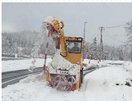
歩道の雪は**小型除雪車**で除雪します。ロータリー除雪車(次回紹介いたします)の小型版で1人乗りです。歩道の幅により**1.1m幅対応の除雪車**と**1.3m幅対応の除雪車**を使い分けています。
