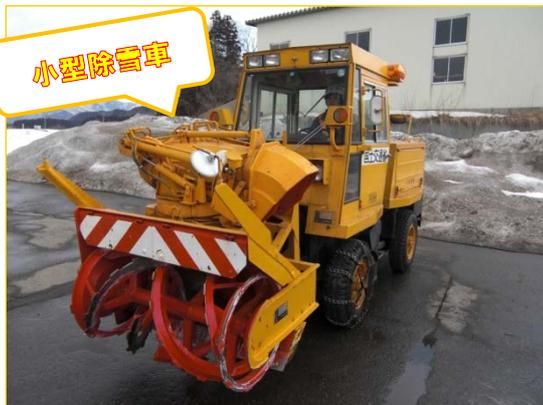
歩道の雪は小型除雪車で除雪します。ロータリ除雪車の小型版で1人乗りです。歩道の幅により1m幅対応の除雪車と1.5m幅対応の除雪車を使い分けています。
