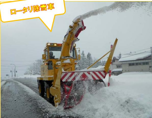
除雪グレーダなどによる作業によって道路の脇に雪が溜まると、車道の幅が狭くなります。道路端が分かりづらくなり車道を逸脱する危険性があるほか、場所によっては大型車両のすれ違いが困難になる等、安全・円滑な交通に支障が出ます。そこでロータリ除雪車で道路の脇に溜まった雪を飛ばして、道の幅を確保します。
