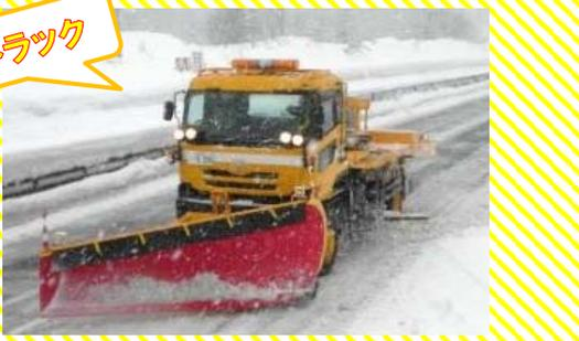
トラックの最前方に、大きな刃の付いた装置（フラウ）を装着しています。
