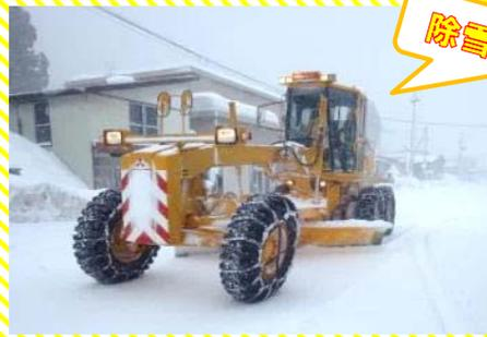
運転席の下にある刃（ブレード）で雪を削り取って道路の端に寄せます。
