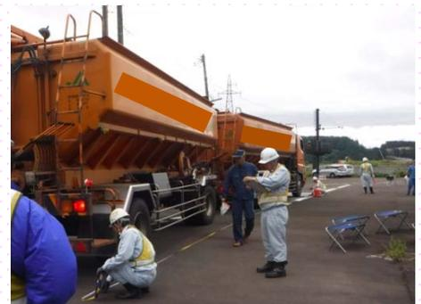
車体の高さ・長さ・幅を測定
