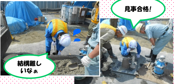
まだ固まらないコンクリートのスラフ（コンクリートの軟らかさ）を測定します。
