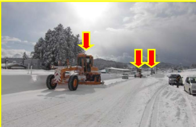
① 1台目は追い越し車線側の雪を中央へ。間隔をあけて3台のグレーダで除雪します。
