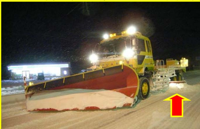
① 追い越し車線（中央分離帯側・右側）の雪を走行車線側（左側）へ寄せます（↑矢印）
