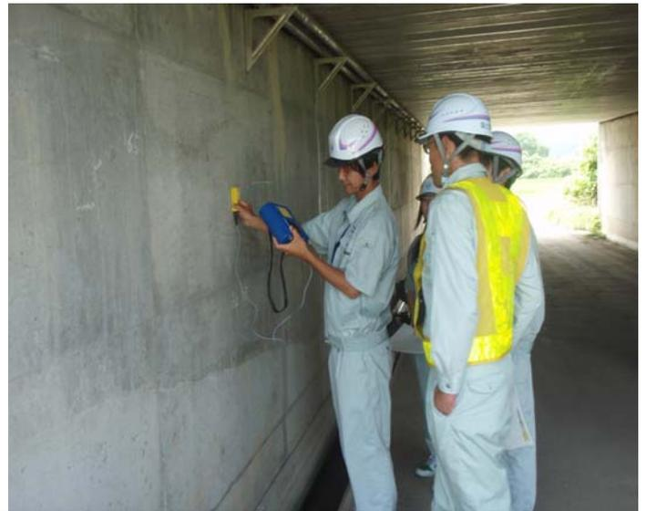
「鉄筋探査」を体験している様子。コンクリート構造物を壊さずに内部の鉄筋を探査できる、非破壊検査という方法です。構造物の品質や強度を確認するために行うものです。
