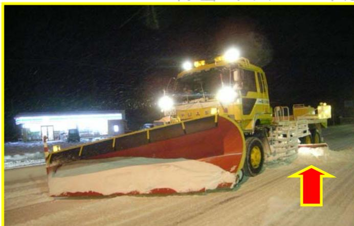
(1) 追い越し車線(中央分離帯側)の雪を走行車線側へ寄せます。
