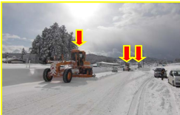
(a) 1台目は追い越し車線側の雪を中央へ。間隔をあけて3台のグレーダで除雪します。
