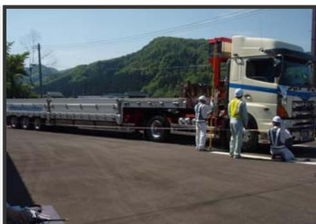
車体の長さ・幅・高さを測定
