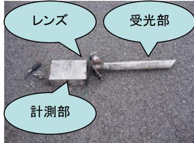
受光部で受けた光をレンズに到達させることで、トンネル内の煙の状況を把握します。排気ガスがこもっているときにはジェットファンが作動します。
