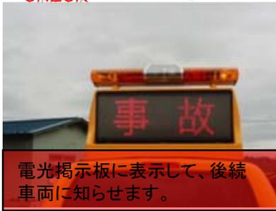
電光掲示板に表示して、後続車両に知らせます。
