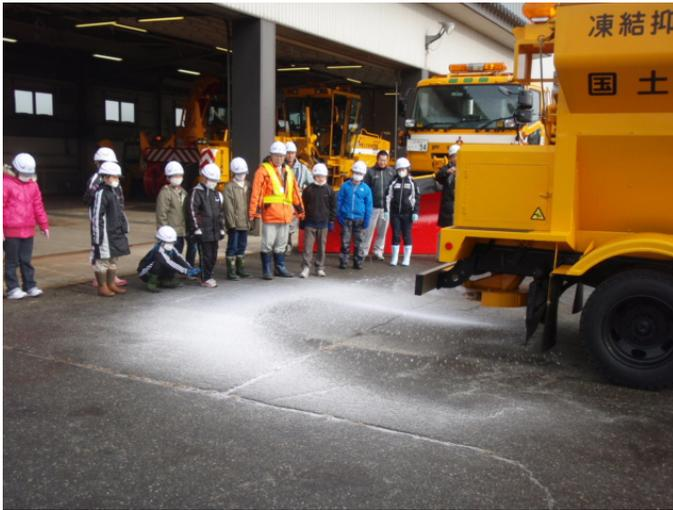
▲凍結抑制剤散布車の実動
