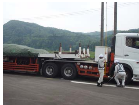
▲高さ・車両の幅・一番遠い車軸間の距離・一番近い車軸間の距離を測定
