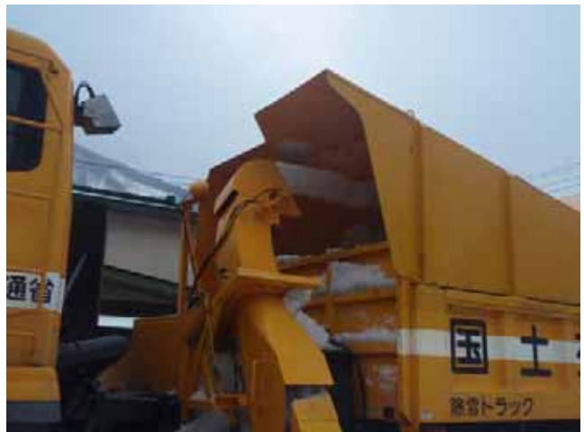
▲赤丸の部分で雪を掻き上げて荷台へ送りこみます。
