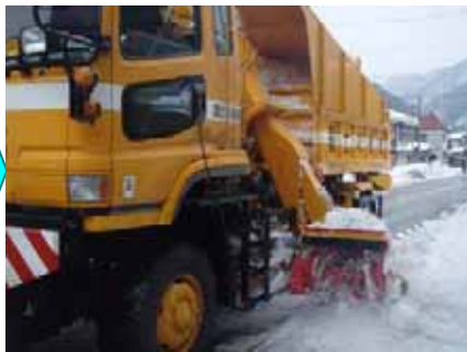
▲赤丸の部分で雪を掻き上げて荷台へ送りこみます。
