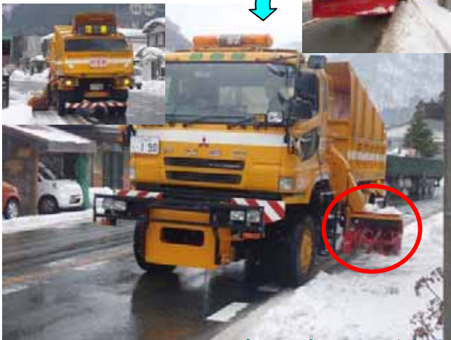
▲赤丸の部分で雪を掻き上げて荷台へ送りこみます。
