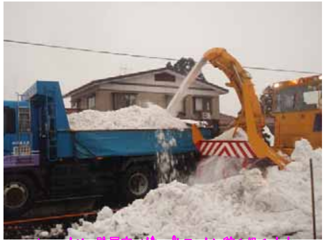
△ローリー除雪車でダンプトラックに積み込みます。
