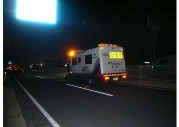
工事着手前に【路面性状調査】を実施。専用車両で測定すると、舗装表面の悪い部分がデータで明らかになります。
