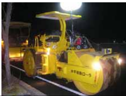
左から順に、【アスファルトフィニッシャー】、【マカダムローラ】、【タイヤローラ】……舗装工事に欠かせないマシン3兄弟です。
