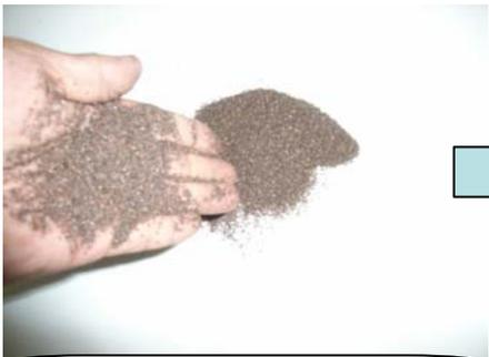
研削材として、ガーネット を使用します。
