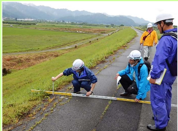
堤防天端の状態を確認、雨水の浸透びり点検
