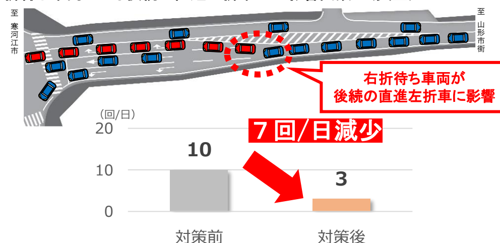
図 朝夕ピーク時の右折待ち車両による後続の直進左折車への影響回数
