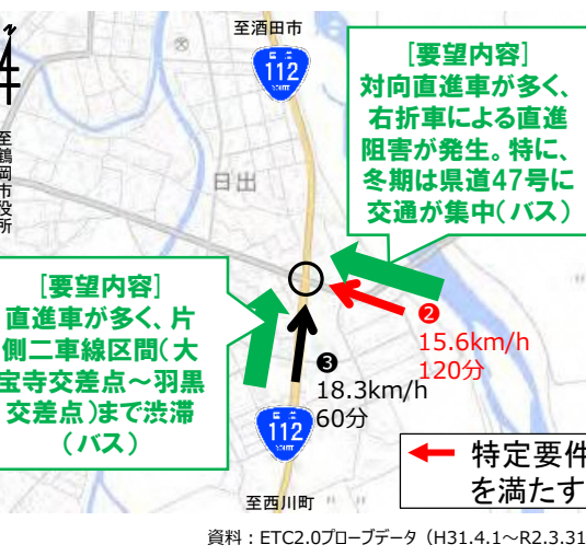
図 要望方向の速度・渋滞継続時間
