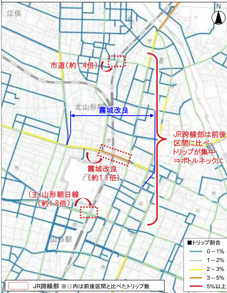
出典：ETC2.0プローブデータより算出 (R1.10、平日7-9時) 図-1 JR跨線部のトリップ集中状況
